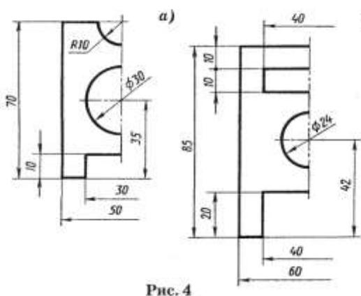
б) Выполните чертежи деталей «Прокладка» по представленным на рисунке 4, а и б половинам изображений, разделенных осью симметрии. Начертите внутреннюю рамку формата А4 (185×287) и основную подпись. Нанесите размеры, в том числе, укажите толщину детали (5 мм); обведите чертеж линиями, установленными стандартом; заполните основную надпись.
