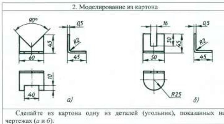
Графическая работа № 4 по теме «Чертежи и аксонометрические проекции предметов»
